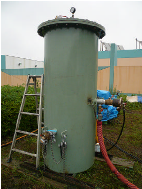
写真 - 3 模擬土質試験圧力容器
